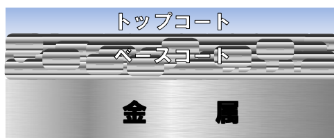
■コーティングの断面イメージ図 (イラスト)
